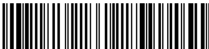
Рисунок 2. Пример кодирования информации в символах штрихового кода GS1-128
